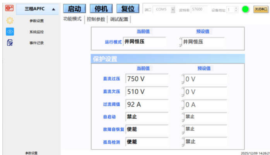
图 4.12 参数设置界面示意图
