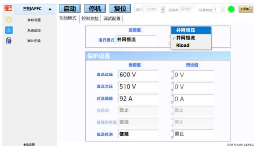
图 4.18 并网恒压模式设置示意图
