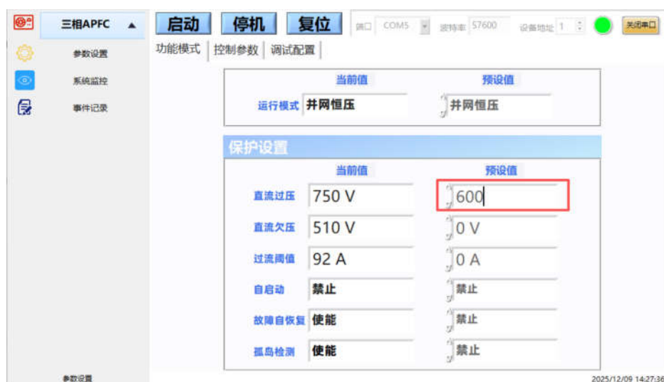
图 4.13 参数设置预设值修改示意图
