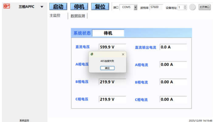
图 4.8 串口连接失败示意图
