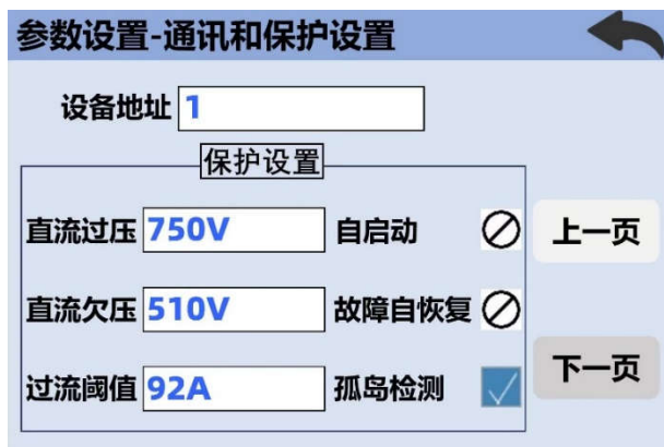
图 5.9 通讯和保护设置屏幕界面示意图
