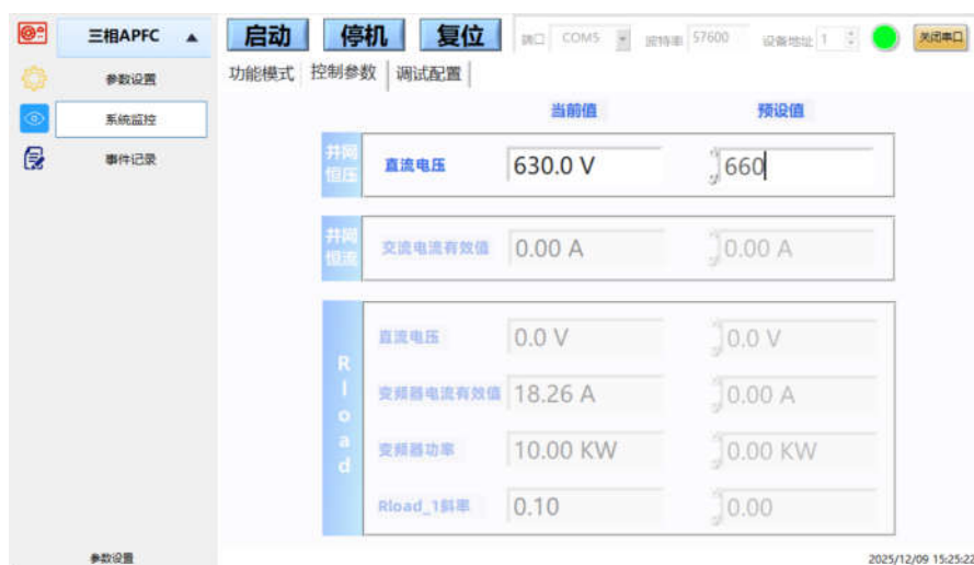
图 4.19 并网恒压模式直流电压设置示意图
